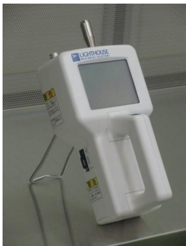
写真24 清浄度測定器 LIGHT HOUSE 社 HANDELD3016
